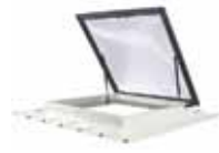
Exutoire de désenfumage avec éclairant ou capot opaque, système d'ouverture et d'une embase d'adaptation à la toiture (source SIH).
